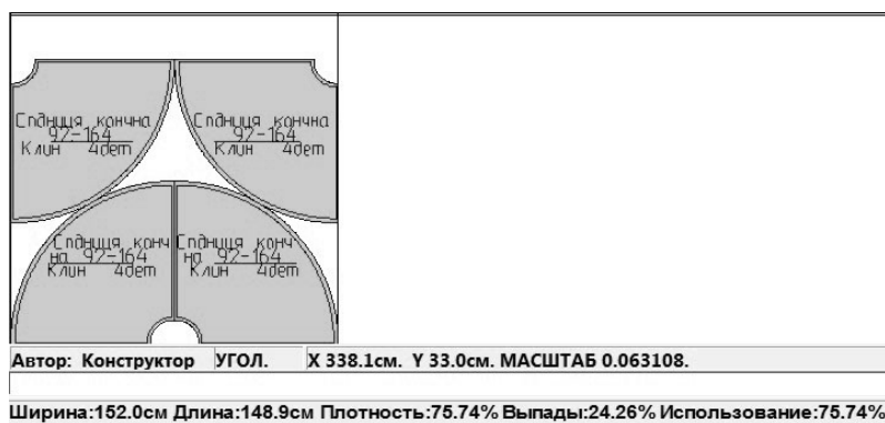
Рис. 3. Фрагмент вікна САПР Грація при виконанні лабораторної роботи “Виконання розкладки моделі конічної спідниці в інтерактивному режимі”
