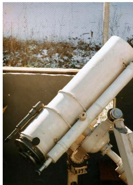
Телескоп системи Річі-Кретьєна D= 400мм
